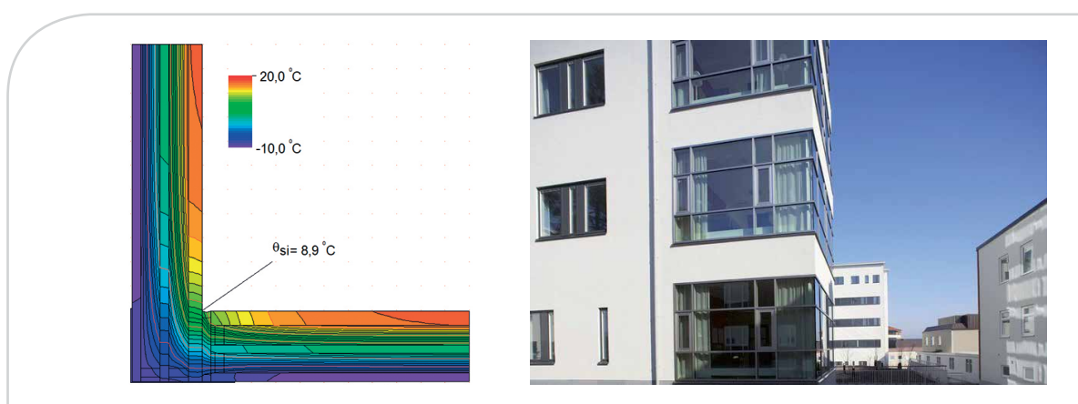
Figur 3.9: Isothermer i limt glasshjørne som viser at kuldebro gir lav overflatetemperatur i hjørne. Foto: Onkologen.
